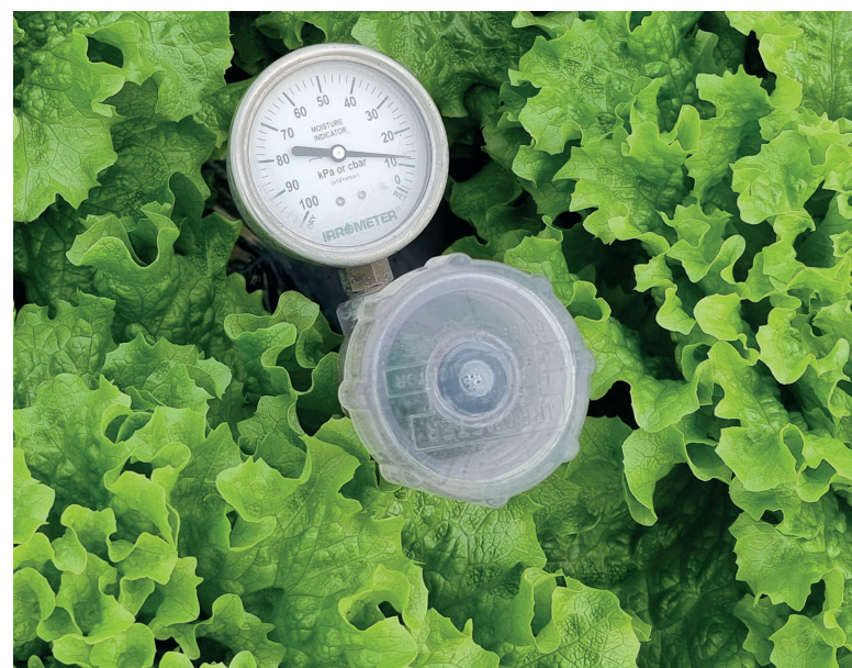
Les tensiomètres aident à savoir quand déclencher les irrigations.
