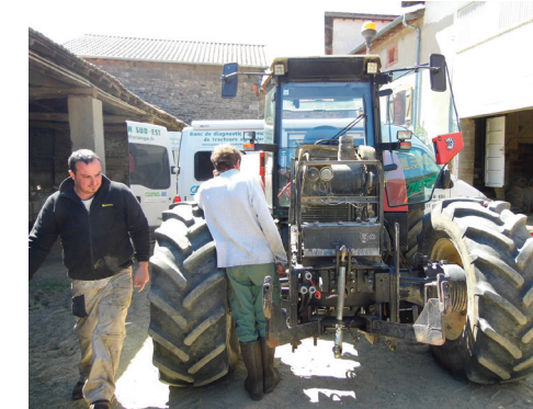
Les Cuma s'intéressent de près au coût et à la rentabilité de leurs machines. Ici, le banc d'essai moteur de la fédération des Cuma d'Aura, qui permet d'évaluer la consommation de carburant des tracteurs.
