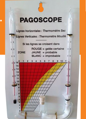
Le pagoscope permet de déterminer les risques de gelées par la comparaison de deux thermomètres.
