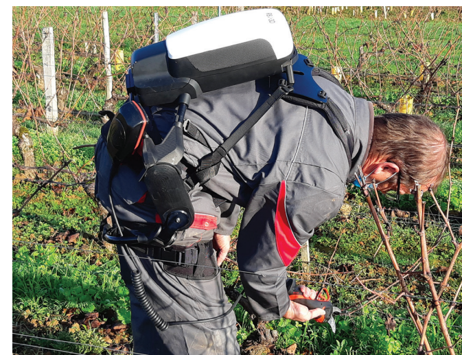
L'Exoback développé par la société bourguignonne RB3D permet de réduire 70 % des efforts sur le rachis lombaire.
